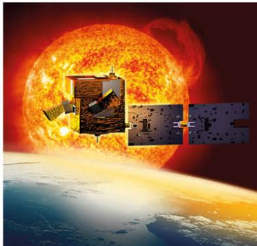
Les différents instruments solaires développés par le LATMOS et ses partenaires permettent d'améliorer notre connaissance du Soleil et de pouvoir mieux estimer l'impact du forçage solaire sur le climat. L'instrument SODISM à bord du satellite PICARD, est un télescope de type Ritchey-Chrétien qui a permis de faire l'acquisition de plus de 1 million d'images du Soleil entre 2010 et 2014.
