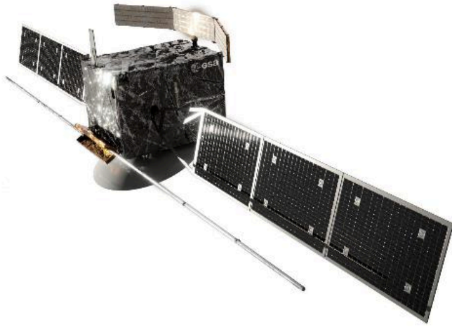
La sonde spatiale EnVision, lancée par Ariane 6.2 en 2022, observera la planète dans de multiples gammes de fréquence, pour l'étude simultanée de la surface, l'intérieur et l'atmosphère de notre proche voisine. Crédits: Observatoire de Paris / VR2Planets
