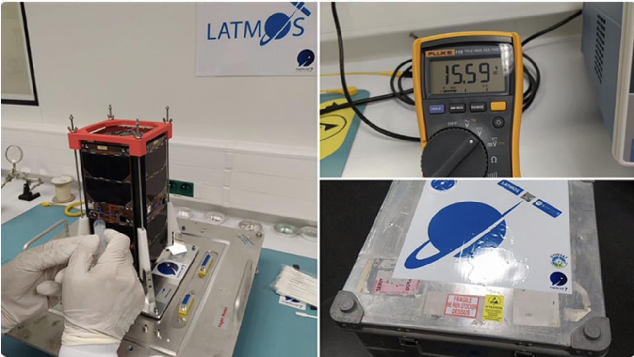
3 février 2023 - Les bouchons ABF (Apply Before Flight) ont été scellés après vérification de la batterie. Le satellite est maintenant en configuration de vol complète.
