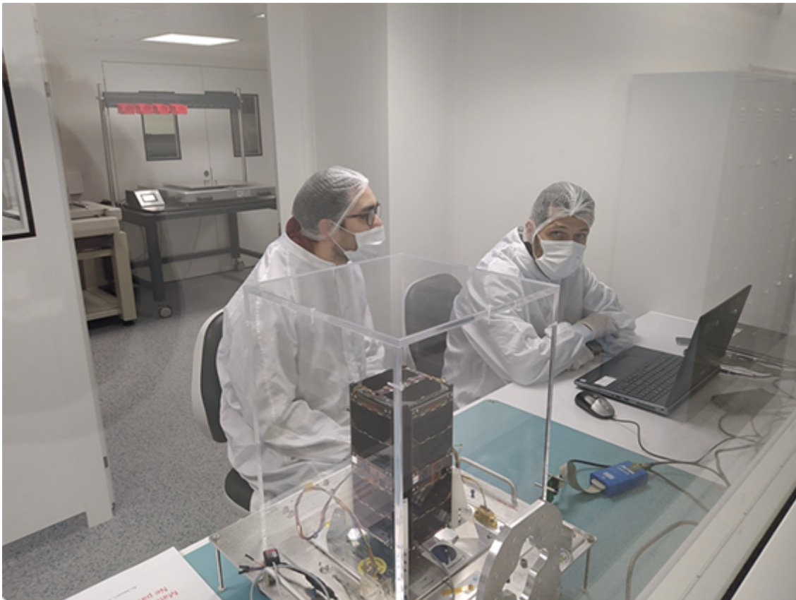
12 décembre 2022 - Tests complémentaires de la charge utile IONO avec Kevin de l'ONERA. Réglage de la communication I2C pour obtenir des données de la mémoire EEPROM ("Electrically Erasable Programmable Read-Only Memory" (mémoire en lecture seule programmable électriquement effaçable)).
