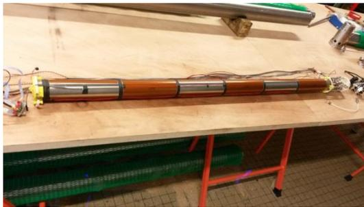
Le spectromètre laser OF-CEAS embarqué à l'intérieur de la sonde. L'instrument lui-même fait seulement 40 mm de diamètre. Il est inséré ici dans un tube-pression sous vide dont le diamètre est de 50 mm.
