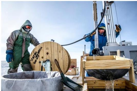
Premier test du prototype de la sonde expérimentale Mini-Subglacier, sur la base Concordia, en Antarctique. Les ingénieurs vérifient la bonne remontée des copeaux de glace à la surface.
