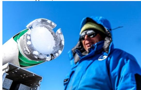
Prélèvement d'une carotte de glace lors des tests du prototype de la sonde expérimentale Mini-Subglacier, sur la base Concordia, en Antarctique. La sonde Subglacier permettra, en une seule saison sur le terrain (2 à 3 mois), d'explorer la glace jusqu'à 3 km de profondeur pour obtenir des enregistrements climatiques des dernières 1,5 millions d'années, les plus anciens à partir de glace naturelle.
