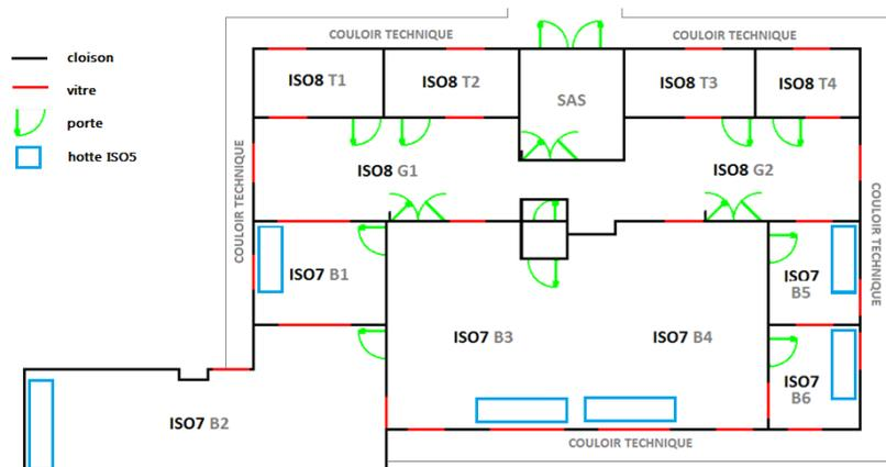
Réalisées par la société Euroflux, les 270m<sup>2</sup> d'espaces propres de la PIT sont répartis en deux zones de propreté : 4 pièces en ISO 8 (classe 100 000) et 5 pièces en ISO 7 (classe 10 000). Chaque salle de la zone ISO7 est également pourvue d'un à trois mètres linéaires de flux laminaire ISO5 (classe 100) sur une paillasse de travail.
